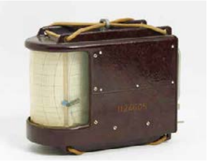
419 BAROGRAPH. Berlin-Steglitz. Firma R. Fuess. Bakelit-Gehäuse, Metall, Papier, Gum- mibänder. Misst den zeitlichen Verlauf des Luftdrucks. 16,5x20,5x10,5 cm. An der Seite Modellnummer '1124605', hinten bez. 'R. Fuess. Berlin-Steglitz' und 'M178ae W1124605 Papier Nr. 216'. Zustand B. € 50 | $ 53
