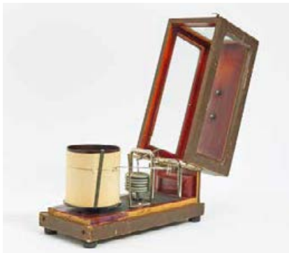
455 ANEROID-BAROGRAPH. Russland. Holzkasten mit Glaseinsatz und Kunstlederüberzug, Bakelittrommel, Armaturen mit Nickel-Belag. Mechanismus mit Uhrwerk für 8 Tage Laufzeit. 22x29x13,5 cm. Oben am Kasten Plakette mit kyrillischem Namen und Modellnr. 536703. Zustand C. € 200 | $ 212
